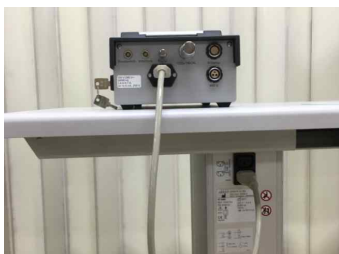
<그림2 진료대와 컨트롤 유닛 전원 연결 모습>
