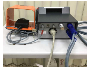
<그림4 풋 스위치가 연결된 모습>
