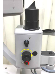
<그림8 세극길이/폭조절 손잡이 회전 모습>
