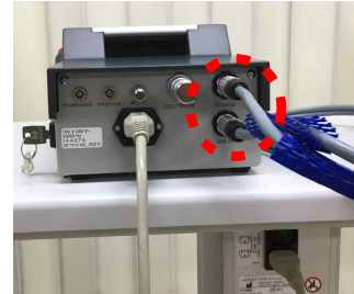
<그림3 슬릿램프 전원코드가 컨트롤 유닛에 연결된 모습>
